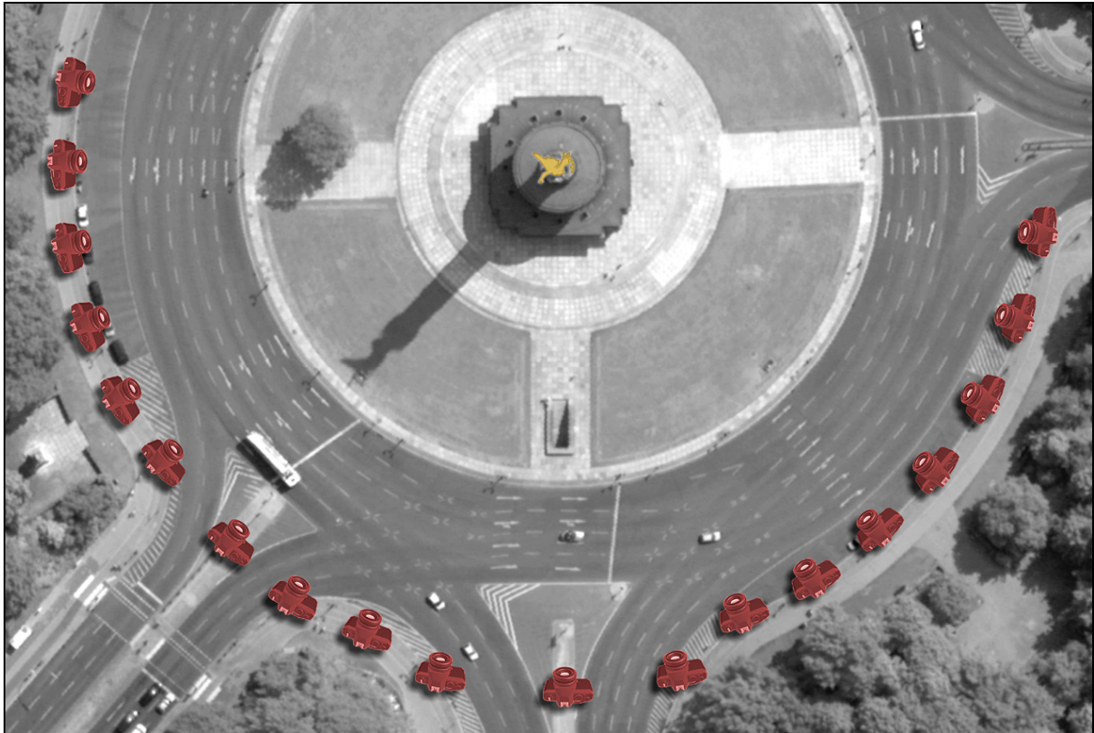
Abb. 6.8: Rekonstruktion der äußeren Orientierung am Beispiel der VIKTORIA-Statue. Die Kameras sind zur Illustration manuell in einen Luftbildausschnitt der HRSC-A vom DLR Berlin eingepasst worden.
