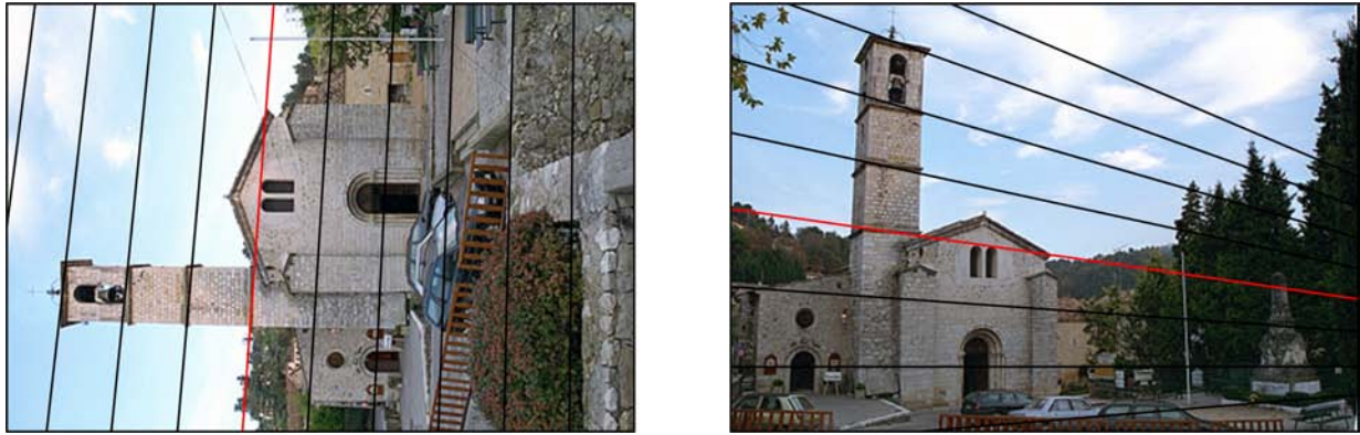
Abb. 4.16: Automatisch geschätzte Epipolar-Geometrie für die Bilder der Kirche in VALBONNE ohne die Modellierung der radialen Objektivverzeichnung
